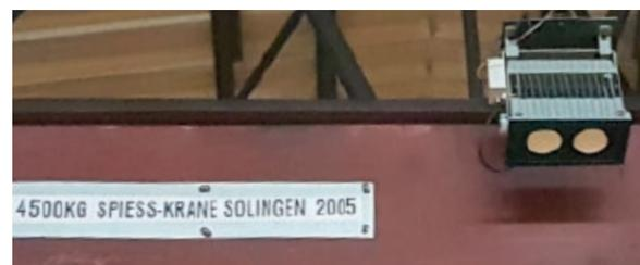
gungsgedämpften Halterungen eignen sie sich speziell für die Montage an Krananlagen.
